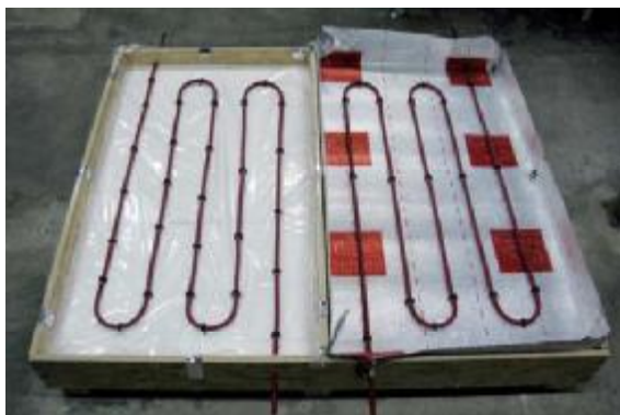
Obr. 2 Podlahová otopná plocha před betonáží vlevo – PE fólie; vpravo – termoreflexní fólie
